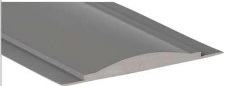
Possibilité de couper la languette si le revêtement est plus épais. Double encollage polychloroprène. Masticage des pieds (mastique PU ou MS Polymère).
